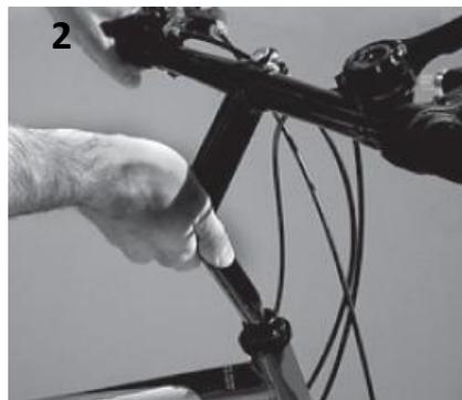
2 Quite el tapón de protección de la taza de dirección y afloje el perno central en el headset utilizando la llave indicada. Inserte el manubrio dentro de la taza de dirección a la marca mínima de inserción, asegúrese que ambos, manubrio y horquilla den hacia el frente. Para ajustar el manubrio al ángulo correcto afloje el perno utilizando la llave indicada en la tabla debajo y asegúrese que la abrazadera este firmemente apretada.
