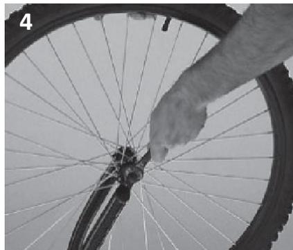
Gire la bicicleta de cabeza y repóselas en el asiento y el manubrio. Inserte la rueda delantera en la horquilla cuando sea suministrada, asegúrese que la araña de la taza de dirección debajo de la tuerca de la rueda esta posicionada en la ranura de la horquilla. Esta araña asegura que la rueda no se caerá y que las tuercas se aflojarán. Apriete las tuercas de la rueda usando una llave de 14/15mm.
