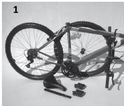
1 Quite las tiras que sostienen la rueda delantera y manubrio, el ensamble y empaquetado contiene los siguientes componentes: poste de asiento y pedales. Remueva el papel protector de su bicicleta.
