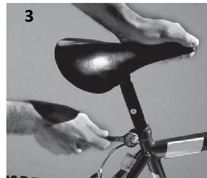
3 Inserte la parte pequeña del asiento dentro de la abrazadera y apriete, después inserte el poste de asiento ensamblado dentro del tubo de asiento de la bicicleta (como se muestra), observando la marca mínima de inserción en el poste de asiento. Apriete la abrazadera del tubo de asiento usando la abrazadera de ajuste rápido.
